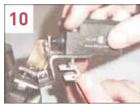
10 按图9所示位置定位、固定开关，揭开胶布，将子板牢牢地向上按在支架上，并将两根螺栓穿过通孔用两套垫圈及螺母固定开关
