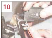
10 Con il fincorsa posizionato e fissato in posizione come indicato in fig. 9, rimuovere la copertura del nastro adesivo, premere con decisione il sottopiatra contro la staffa, lasciando fuoriuscire le due viti
