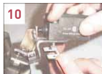
10 Une fois l'interrupteur positionné et maintenu en position comme sur la fig. 9 enlevez l'arrière du ruban adhésif, appuyez fermement sous la plaque pour aller jusqu'au support à l'aide de deux vis passées au travers. Mettez deux rondelles et écrous pour sécuriser l'interrupteur
