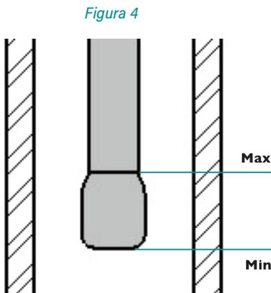
El aceite debe estar dentro del rango de operación correcto para que el amortiguador funcione correctamente.
