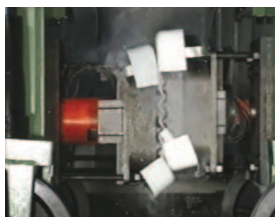
Test di omologazione dispositivo anti-sormonto compresa calotta di copertura dispositivo
