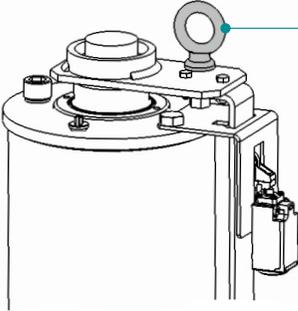
Verwenden Sie die Augenschraube, wenn Sie Oleo MLB 35-40 Puffer anheben, wie in *Abbildung 1* gezeigt.
