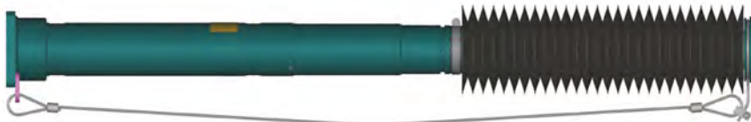
带波纹管 and 钢索的后装缓冲器
