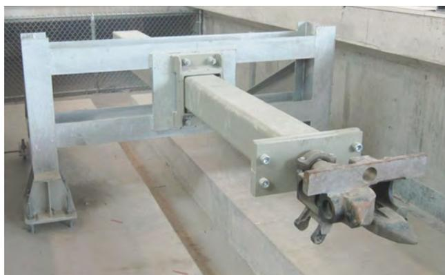
В рамках данного проекта клиент разработал свою собственную стальную конструкцию, которая была установлена на бетонное основание. Рассчитан на удар по центру, оснащен гидравлическими блоками Oleo (два блока Oleo, тип 76 – восстанавливаемый ход: 1200 мм). Масса состава: 115 тонн. Скорость удара: 8 км/ч. Длина конструкции: 3,5 м. Поглощаемая энергия удара: 672 кДж. Конечная сила: 700 кН.
