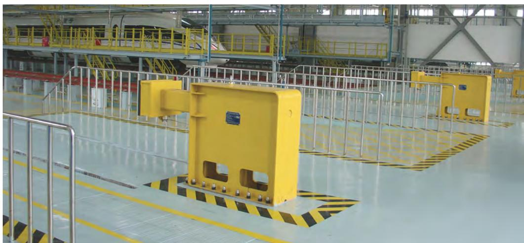
Как правило, используется в депо/ремонтных мастерских – рассчитан исключительно на удар по центру. Фиксированные тупиковые упоры, оснащенные гидравлическим блоком Oleo (один блок Oleo, тип 76 – восстанавливаемый ход 600 мм). Длина конструкции: 2,7 м. Поглощаемая энергия удара: 336 кДж.
