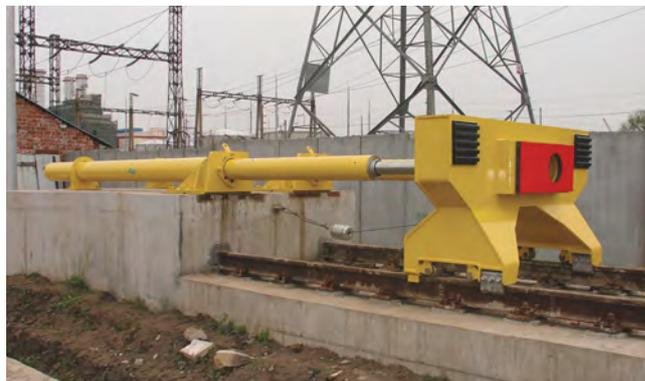
Как правило, используется для линий метрополитена и магистральных линий – рассчитан на удар по центру и боковые удары. Фундамент с бетонным основанием, оснащенный гидравлическими блоками Oleo (два блока Oleo, тип 724 – восстанавливаемый ход: 2400 мм). Масса состава: 300 тонн. Скорость удара: 14 км/ч. Длина конструкции: 8 м. Поглощаемая энергия удара: 2688 кДж.
