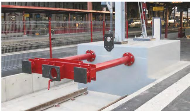
Как правило, используется для линий метрополитена и магистральных линий – рассчитан на удар по центру и боковые удары. Фундамент с бетонным основанием, оснащенный гидравлическими блоками Oleo (два блока Oleo, тип 718 – восстанавливаемый ход: 1800 мм). Масса состава: 267 тонн. Скорость удара: 12 км/ч. Поглощаемая энергия удара: 2016 кДж. Длина конструкции: 5,5 м.
