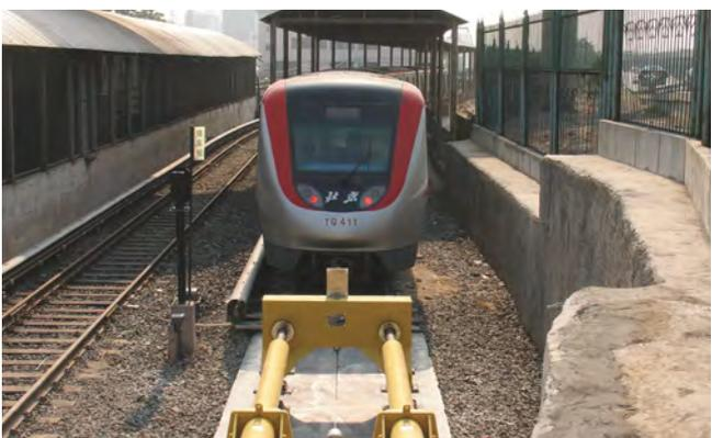
Как правило, используется для линий метрополитена и магистральных линий – рассчитан на удар по центру и боковые удары. Фундамент с бетонным основанием, оснащенный гидравлическими блоками Oleo (два блока Oleo, тип 730 – восстанавливаемый ход: 3000 мм). Масса состава: 510 тонн. Скорость удара: 12 км/ч. Длина конструкции: 9,5 м. Поглощаемая энергия удара: 3360 кДж.
