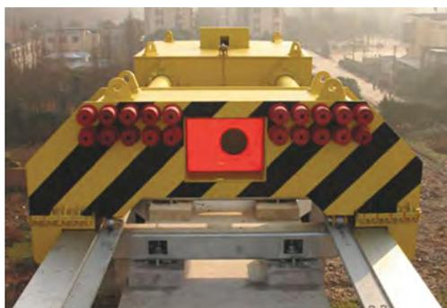
Как правило, используется на низкоскоростных испытательных линиях – рассчитан на удар по центру и боковые удары. Фиксированные тупиковые упоры, оснащенные гидравлическими блоками Oleo (два блока Oleo, тип 718 – восстанавливаемый ход 1800 мм). Длина конструкции: 5,5 м. Поглощаемая энергия удара: 2016 кДж.
