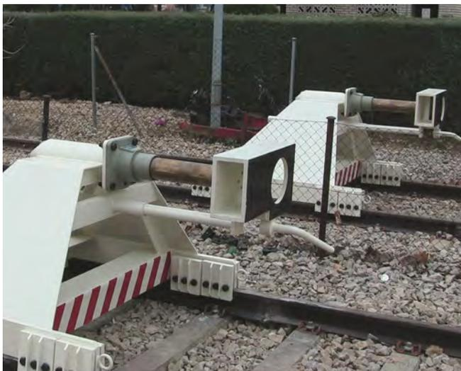
Модели для поездов мадридского метро серий 5000, 6000, 7000, 8000 и 9000. Используется гидравлический блок Oleo (один блок, тип 9 – восстанавливаемый ход 400 мм). Масса состава от 163 до 216 тонн. Максимальная скорость удара 15 км/ч. Длина конструкции: 7,1 м. Поглощаемая энергия удара: 224 кДж.
