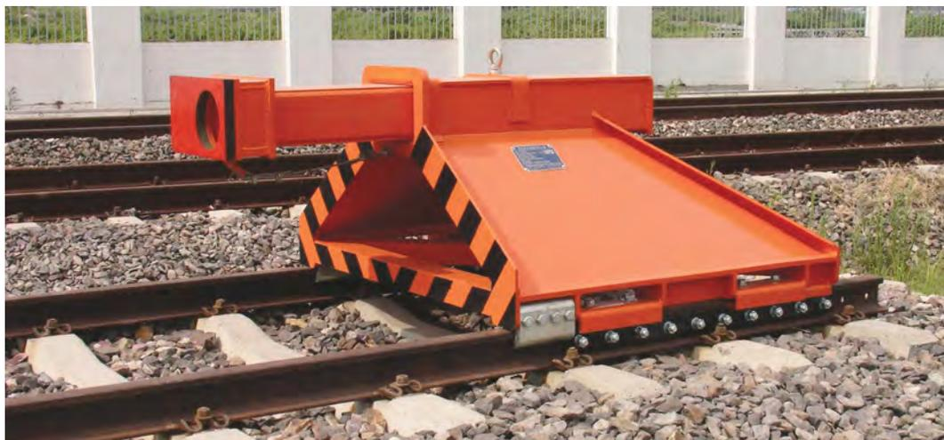
Как правило, используются в конце рельсового пути – рассчитаны исключительно на удар по центру. Фиксированные тупиковые упоры, оснащенные гидравлическими блоками Oleo (один блок Oleo, тип 76 – восстанавливаемый ход 600 мм). Масса состава: 300 тонн. Скорость удара: 5 км/ч. Длина конструкции: 2,8 м. Поглощаемая энергия удара: 336 кДж.
