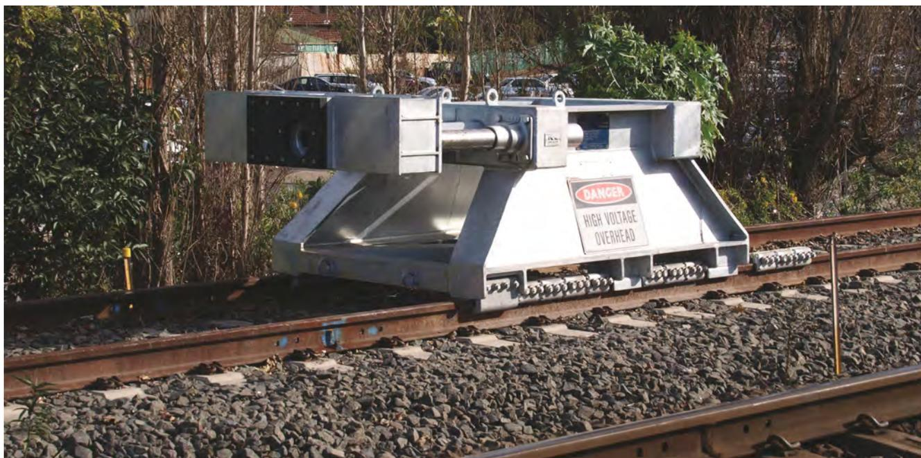
Как правило, используется на магистральных линиях – рассчитан исключительно на удар по центру. Тупиковый упор трения скольжения с девятью парами фрикционных башмаков и одной парой башмаков для предотвращения наползания, установленных спереди. Со встроенными гидравлическими блоками Oleo (два блока Oleo, тип 9 – восстанавливаемый ход 400 мм). Масса состава: 535 тонн. Скорость удара: 25 км/ч. Длина конструкции: 16 м. Поглощаемая энергия удара: 448 кДж
