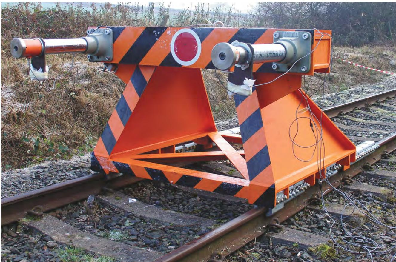
Как правило, используется на европейских магистральных линиях (грузовых) – рассчитан только на боковые удары. Тупиковый упор трения скольжения (восемь фрикционных башмаков) со встроенными гидравлическими блоками Oleo (два блока Oleo, тип 9 – восстанавливаемый ход 400 мм). Масса состава: 220 тонн. Скорость удара: 25 км/ч. Длина конструкции: 25 м. Поглощаемая энергия удара: 448 кДж.
