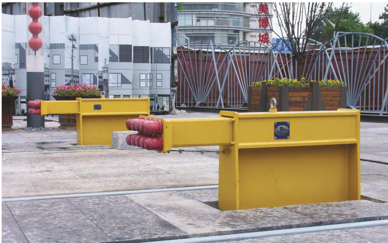
Данный тупиковый упор был спроектирован в рамках специального реконструкционного проекта, целью которого было создание ретро-трамвая в Пекине – рассчитан на удар по центру и оснащен резиновыми амортизаторами. Фиксированный тупиковый упор, оснащенный гидравлическим блоком Oleo (один блок Oleo, тип 54 – восстанавливаемый ход 400 мм). Поглощаемая энергия удара: 160 кДж.
