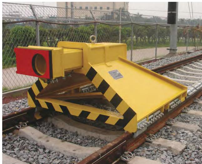
Как правило, используется на линиях метро – рассчитан исключительно на удар по центру. Тупиковый упор трения скольжения (двадцать фрикционных башмаков) со встроенным гидравлическим блоком Oleo (один блок, тип 9 – восстанавливаемый ход 400 мм). Масса состава: 220 тонн. Скорость удара: 25 км/ч. Длина конструкции: 16 м. Поглощаемая энергия удара: 224 кДж.
