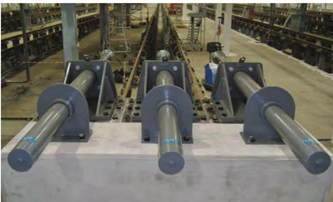
Как правило, используется для линий метрополитена, магистральных линий и депо – рассчитан на удар по центру и боковые удары. Фундамент с бетонным основанием, оснащенный гидравлическими блоками Oleo (три блока Oleo, тип 712 – восстанавливаемый ход: 1200 мм). Масса состава: 1000 тонн. Скорость удара: 1,94 м/с. Поглощаемая энергия удара: 2016 кДж. Длина конструкции: 3,5 м.
