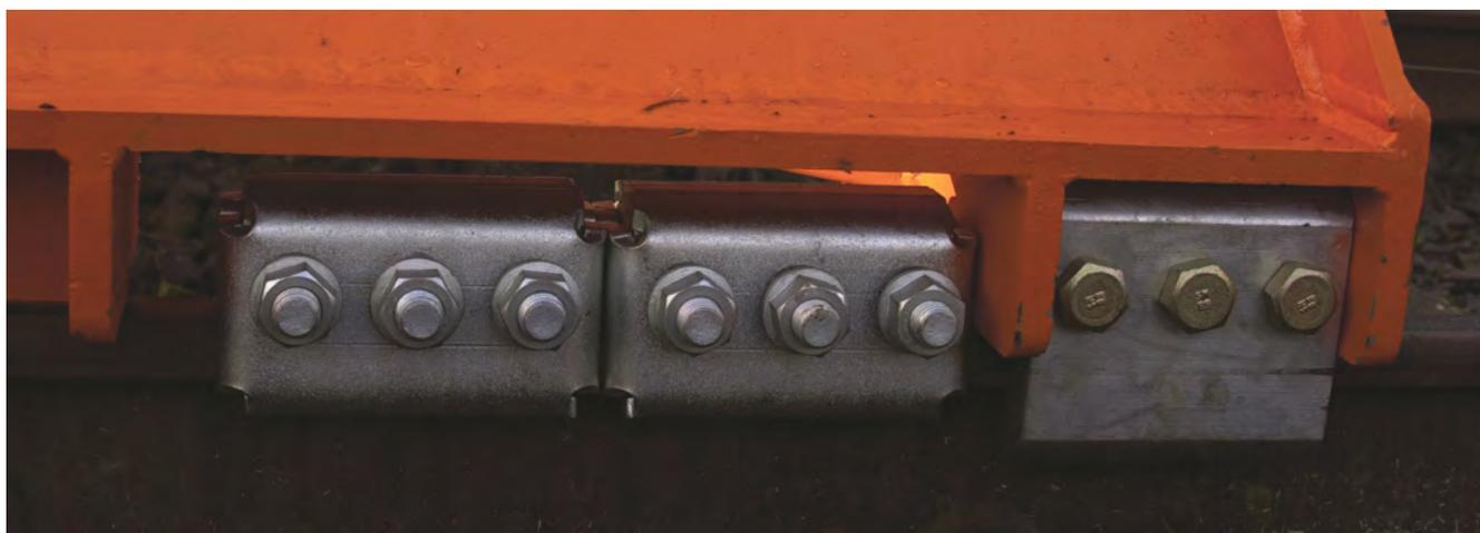
Фрикционные башмаки и узел предотвращения наползания.
