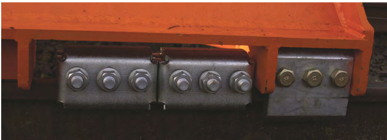
Detalhe de sapatas de fricção e montagem antissubida.
