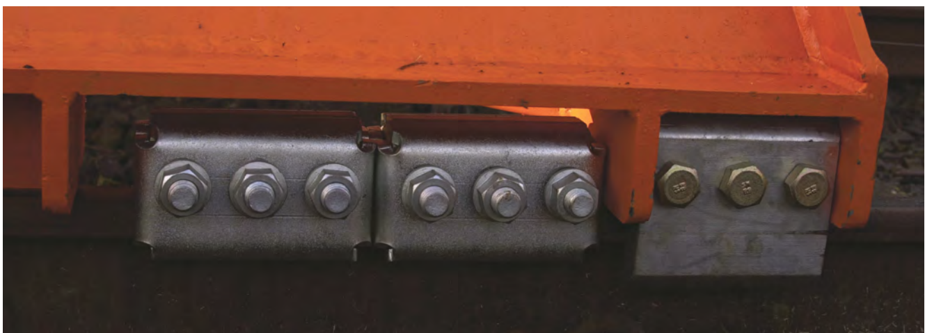
Vue détaillée des sabots de friction et de l'ensemble anti-chevauchement.
