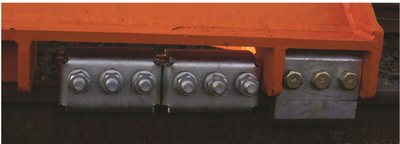
Detalle de las zapatas de fricción y del juego anticlimber.
