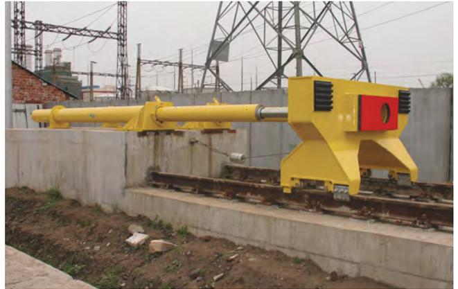
Üblicherweise auf Metro- und Hauptstrecken eingesetzt – für Mitten- und Seitenaufprall konzipiert. Betonfundamentsockel mit Oleo-Hydraulikeinheiten (zwei Oleo Typ 724 – wiederherstellbare Einfederung 2400mm). Zugmasse: 300 Tonnen, Aufprallgeschwindigkeit: 14 km/h, Einbaulänge: 8 Meter, Aufpralleistung 2688 kJ.
