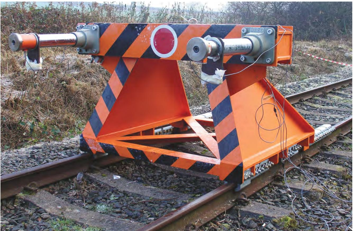
Üblicherweise auf europäischen Hauptstrecken eingesetzt (Fracht) – nur für Seitenaufprall ausgelegt. Bremsprellbock (acht Bremschuhe) mit Oleo Hydraulikeinheiten (zwei Oleo Typ 9 – wiederherstellbare Einfederung 400 mm). Zugmasse: 220 Tonnen, Aufprallgeschwindigkeit: 25 km/h, Einbaulänge: 25 Meter, Aufpralleistung: 448 kJ.
