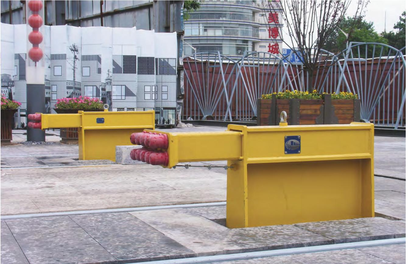
Dieser Prellbock wurde für ein spezifisches Wiederaufbauprojekt für ein Tramsystem alten Stils in Peking entwickelt – für Mittenaufprall konzipiert, mit Gummidämpfung. Festprellbock mit Oleo-Hydraulikeinheit (ein Typ 54 – wiederherstellbare Einfederung 400 mm). Aufprallleistung: 160 kJ.
