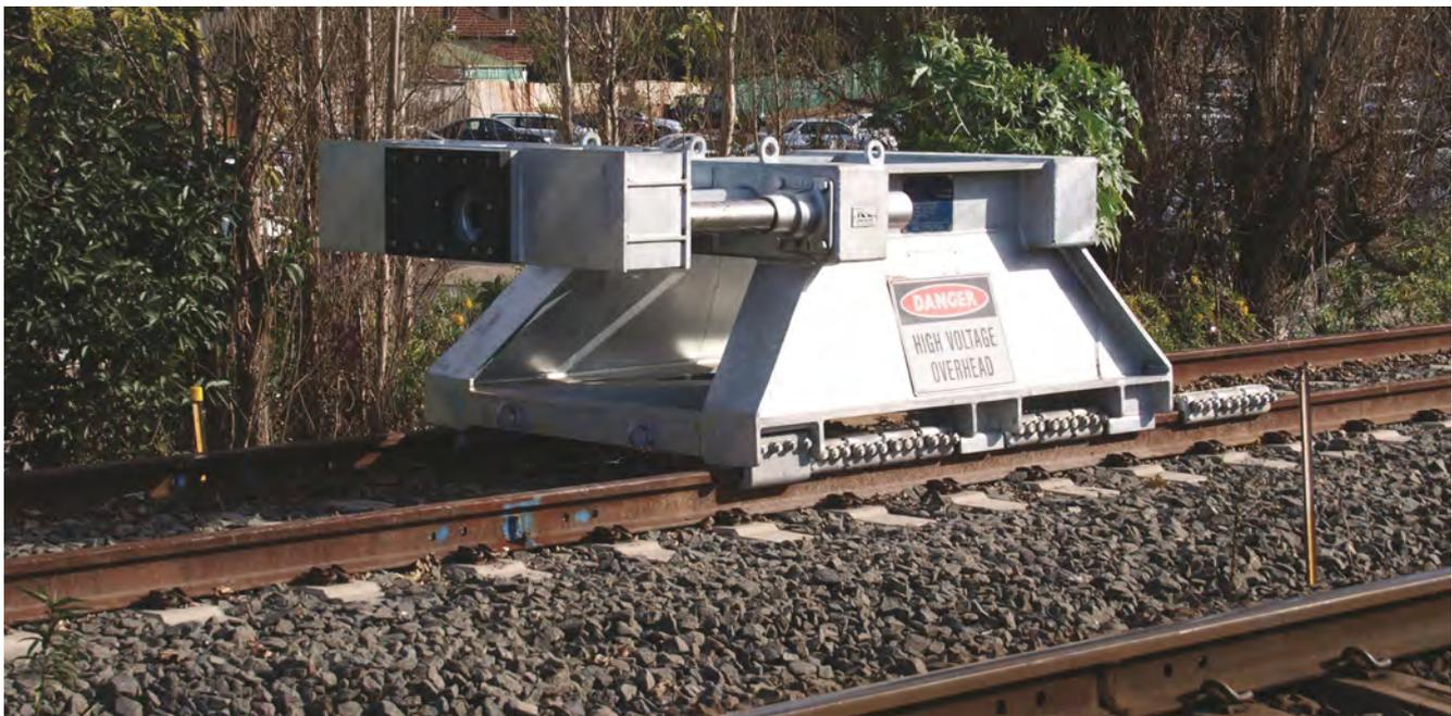
Üblicherweise auf Hauptstrecken eingesetzt – nur für Mittenaufprall ausgelegt. Bremssprellbock mit neun Bremsschuhpaaren und einem Paar Aufkletterschutzschuhen an der Vorderseite. Mit Oleo-Hydraulikeinheiten (zwei Oleo Typ 9 – wiederherstellbare Einfederung 400 mm). Zugmasse: 535 Tonnen, Aufprallgeschwindigkeit: 25 km/h, Einbaulänge: 16 Meter, Aufpralleistung: 448 kJ.
