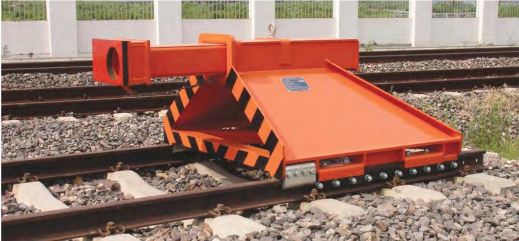
Üblicherweise am Gleisende eingesetzt – nur für Mittenaufprall konzipiert. Festprellbock mit Oleo Hydraulikeinheiten (einmal Oleo Typ 76 – wiederherstellbare Einfederung 600 mm). Zugmasse: 300 Tonnen, Aufprallgeschwindigkeit: 5 km/h, Einbaulänge: 2,8 Meter, Aufpralleistung: 336 kJ.
