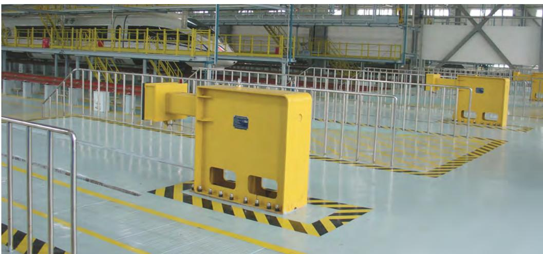
Üblicherweise in Depots/Wartungswerkstätten eingesetzt – nur für Mittenaufprall konzipiert. Festprellbock mit Oleo-Hydraulikeinheit (ein Oleo Typ 76 – wiederherstellbare Einfederung 600 mm). Einbaulänge: 2,7 Meter, Aufpralleistung 336 kJ.
