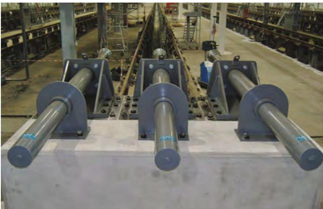
Üblicherweise auf Metro- und Hauptstrecken sowie in Depots eingesetzt – für Mitten- und Seitenaufprall konzipiert. Betonfundamentsockel mit Oleo-Hydraulikeinheiten (drei Oleo Typ 712 – wiederherstellbare Einfederung: 1200 mm). Zugmasse: 1000 Tonnen, Aufprallgeschwindigkeit: 1,94 m/s, Aufpralleistung 2016 kJ, Einbaulänge: 3,5 m.
