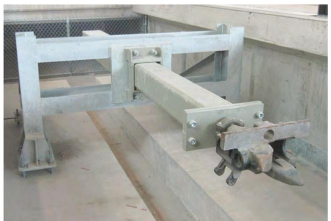
Bei diesem Projekt entwickelte der Kunde seine eigene Stahlstruktur, die auf dem Betonsockel angebracht wurde. Für Mittenaufprall konzipiert, mit Oleo-Hydraulikeinheiten (zwei Oleo Typ 76 – wiederherstellbare Einfederung 1200 mm). Zugmasse: 115 Tonnen, Aufprallgeschwindigkeit: 8 km/h, Einbaulänge: 3,5 Meter, Aufpralleistung 672 kJ, Endkraft: 700 kN.
