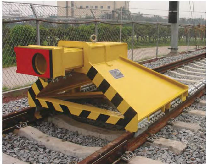
Üblicherweise auf Metrostrecken eingesetzt – nur für Mittenaufprall ausgelegt. Bremsprellbock (zwanzig Bremschuhe) mit Oleo-Hydraulikeinheit (einmal Typ 9 – Wiederherstellbare Einfederung 400 mm). Zugmasse: 220 Tonnen. Aufprallgeschwindigkeit: 25 km/h. Einbaulänge: 16 Meter. Aufpralleistung: 224 kJ.
