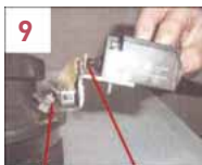
9 Palanca tocando ligeramente la varilla de empuje 10 Palanca tocando ligeramente el émbolo del interruptor
