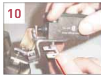
10 Mit dem Schalter positioniert und in Position gehalten, wie Abb. 9, entfernen Sie die eine Seite vom Klebeband, drücken Sie die Platte fest bis zur Halterung mit 2 hervorstehenden Schrauben Ziehen Sie zwei Unterlegscheiben und Muttern an Sichern Sie den Schalter
