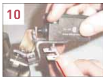
10 Con el interruptor colocado y mantenido en posición como indicado en la figura 9, eliminar la protección de la cinta adhesiva, presionar firmemente la placa contra el soporte, con los dos tornillos sobresaliendo por debajo. Colocar dos arandelas y dos tuercas para asegurar el interruptor
