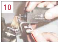
11 図9のようにスイッチを定位置に固定し、粘着テープから裏紙を剥がし、サブプレートに2本のネジを通してブラケットに押し当てます。2つのワッシャーとナットでスイッチを固定します
