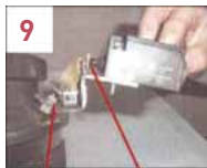
9 Hebel berührt leicht die Schubstange Hebel berührt leicht den Schalterkolben
