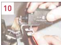
10 Con il fincorsa posizionato e fissato in posizione come indicato in fig. 9, rimuovere la copertura del nastro adesivo, premere con decisione il sottopiastra contro la staffa, lasciando fuoriuscire le due viti
